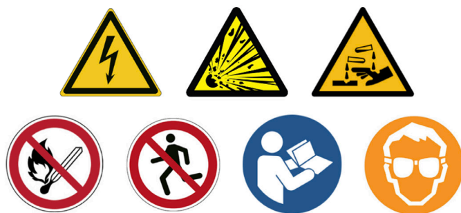
Figura 16. Señales de advertencia
