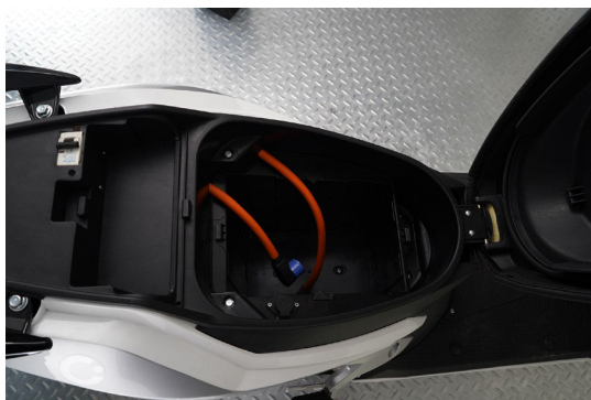
Figura 18. Connexió inferior de la bateria
