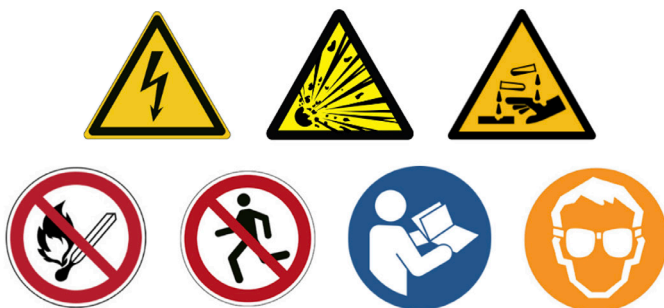
Figura 23. Señales de advertencia
